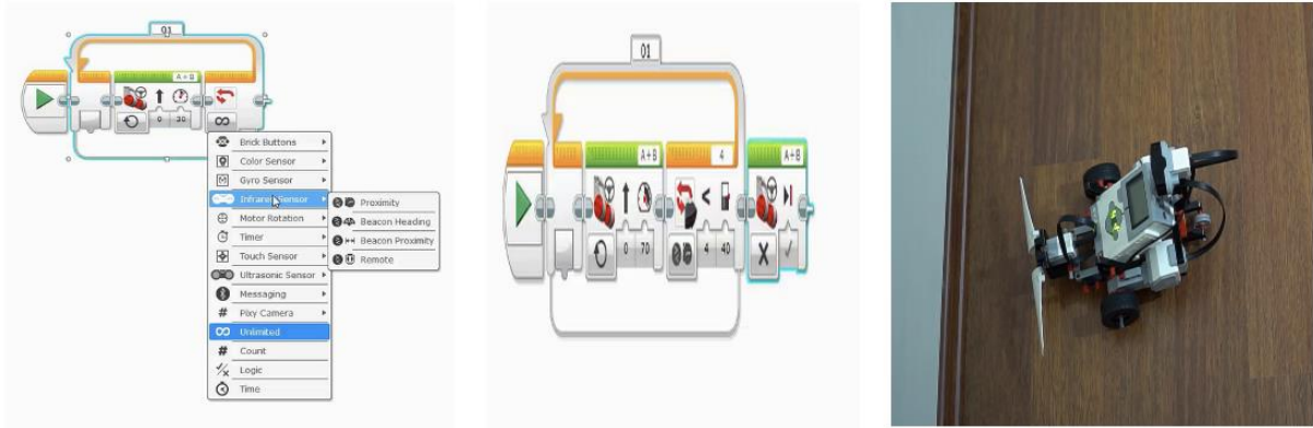
Şekil 3. İnfrared sensör kodları ve engele çarpıma uygulaması
