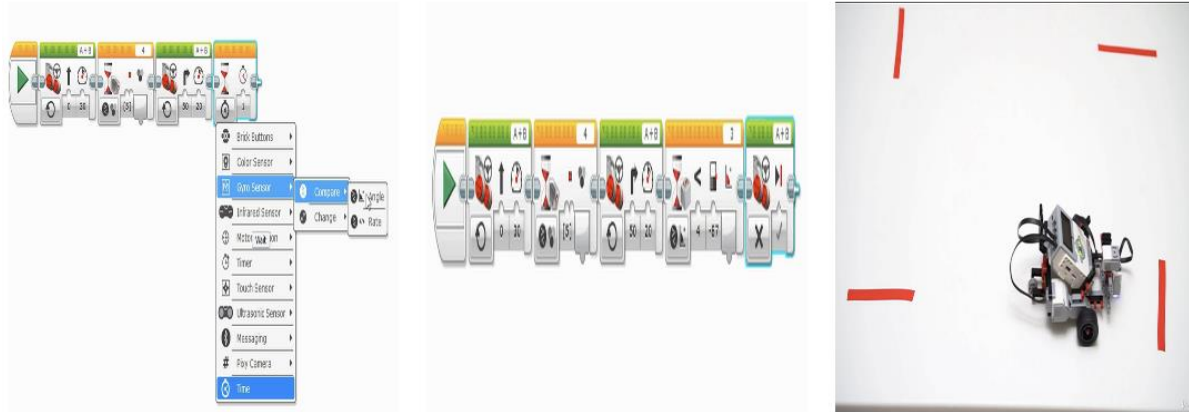
Şekil 6. Gyro sensör kodları ve açı ölçme uygulaması
