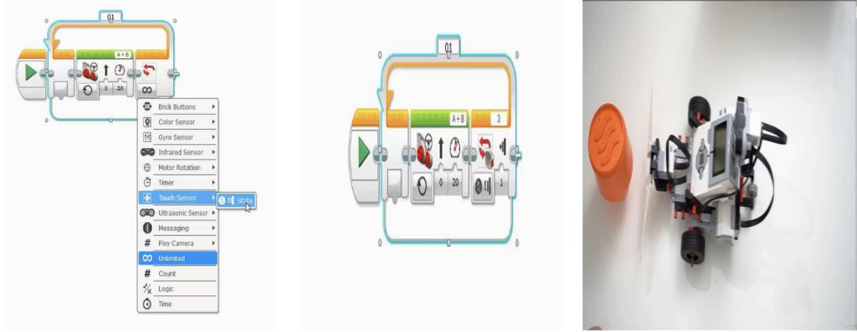
Şekil 2. Touch sensör kodları ve engele çarpıma uygulaması
